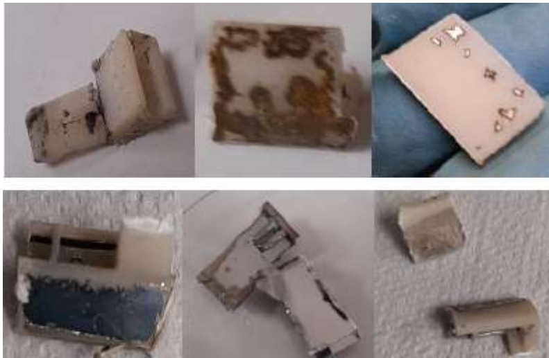
Figura 14. Piezas de ABS tratadas en condiciones no óptimas de lixiviación
