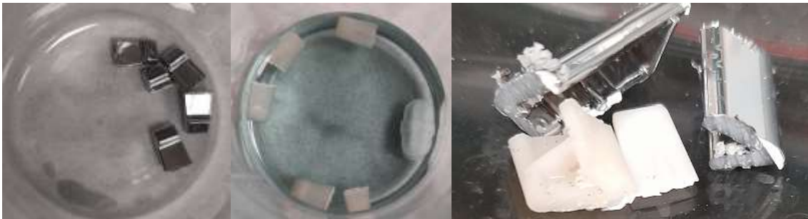
Figura 16. Piezas ABS antes, durante y después del tratamiento
