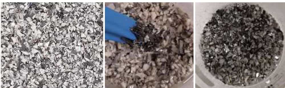
Figura 19. Inicial, separando con imán y metal concentrado con el imán
