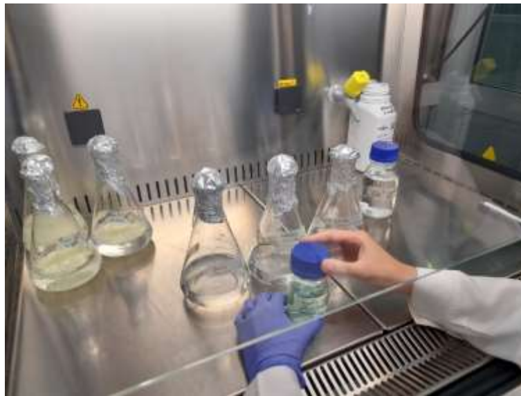
Figura 6. Preparación del medio 9K para preparar sub-cultivos de las especies bacterianas. Por un lado en erlenmeyers estaba la solución OK esterilizada y por otro la solución de hierro (II) esterilizada.
