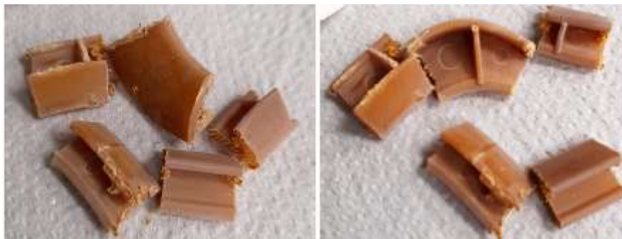
Figura 11. Piezas de ABS tras ser digeridas en agua regia a temperatura
