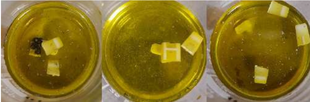
Figura 13. Lixiviado ABS con distintos ácidos residuales de decapado
