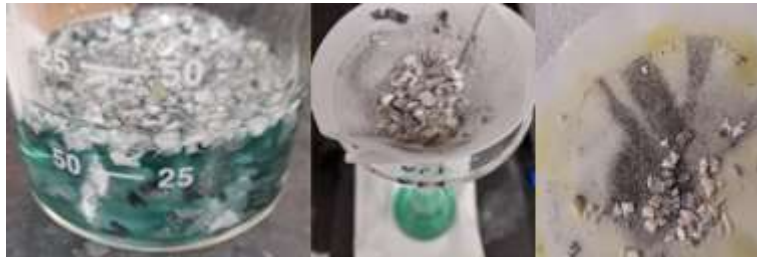
Figura 21. Tratamiento del ABS triturado con pH ácido y hierro (III)
