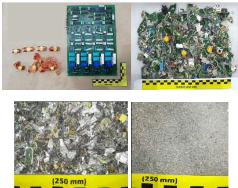
Figura 24. Ejemplo de la muestra inicial, triturado y final (separación física) para los ensayos
