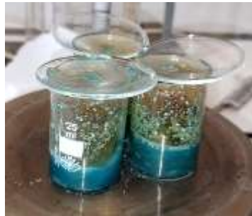
Figura 29. Tratamiento con ácido concentrado y temperatura
