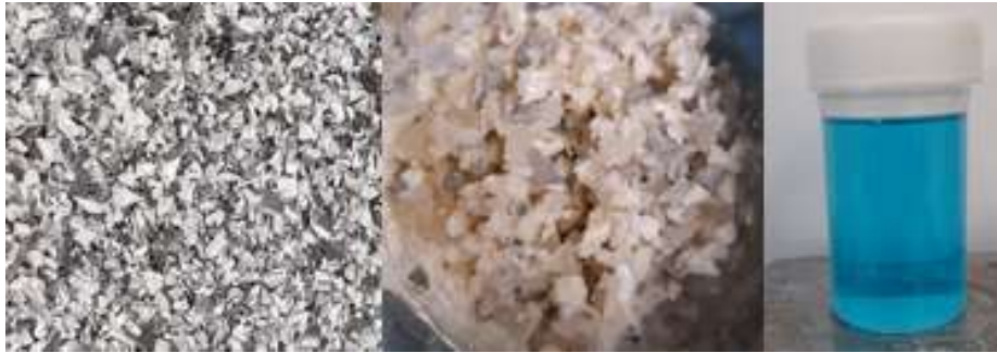
Figura 20. ABS inicial, ABS valorizable final y metales disueltos respectivamente
