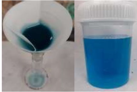
Figura 28. Filtración y disolución final rica en cobre procedente de los circuitos
