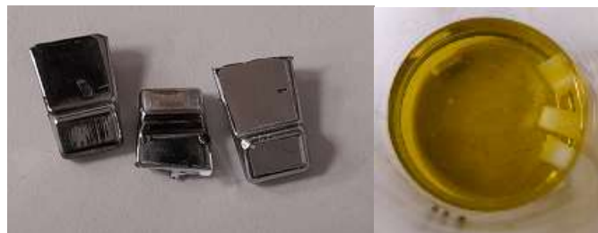
Figura 15. Piezas ABS tratadas con ácidos de decapado
